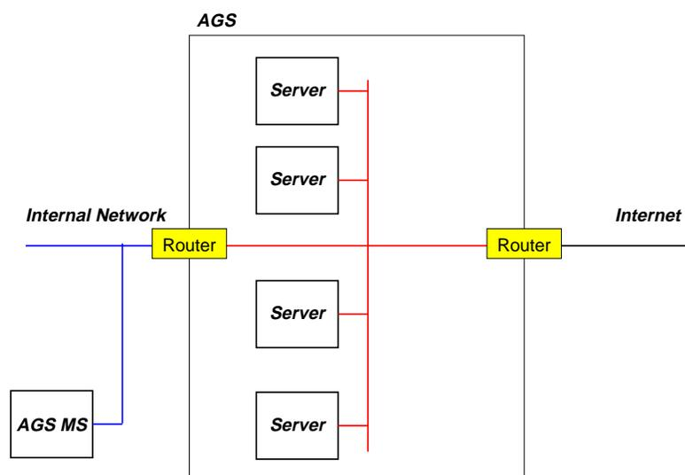
Figure 1. Basic AGS Architecture
